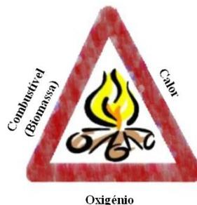
**Figura 1: Modelo do triângulo de fogo**
