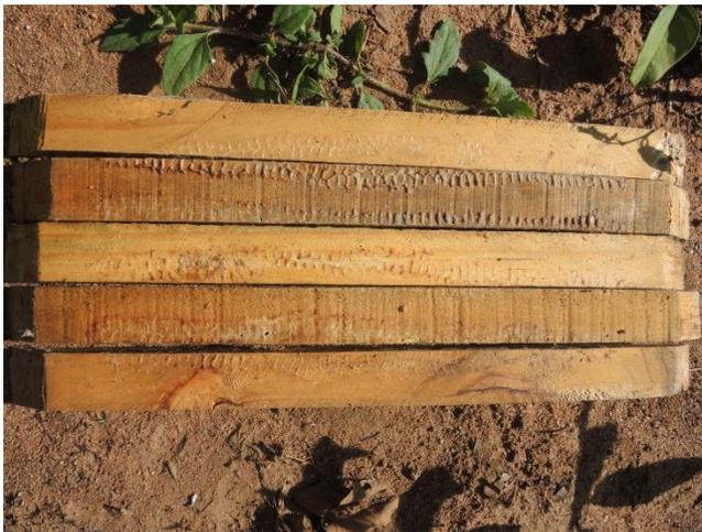
Fig. 18- Deficient top bars
