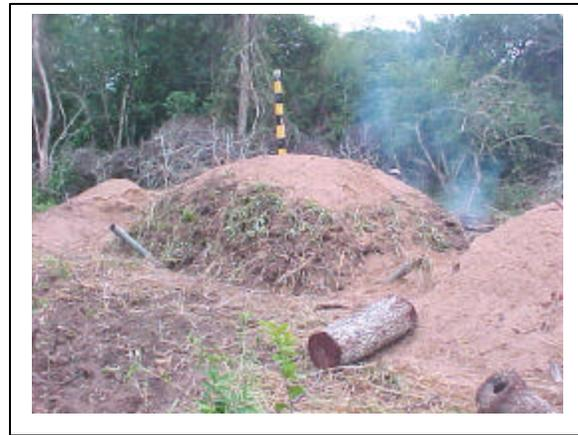
**FIGURA11**      **COBERTURA FINAL DO FORNO COM SOLO HÚMIDO**
