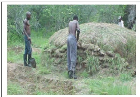
**FIGURA 13** FASE DA COBERTURA COM CAPIM E SOLO HÚMIDO
