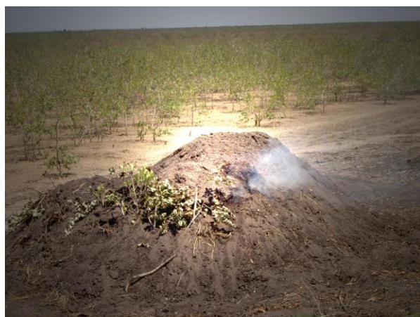
Figura 30: Uso de espécies de mangal para fabrico de carvão (um forno de carvão, Muntanha, estuário de Incomati)
